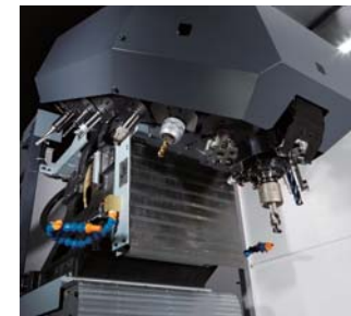
Quantidade de corte: 110 cc/min Material: Aço de carbono (usando fresa de topo D16)
